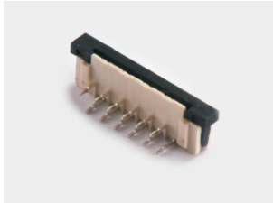
CONN FFC 1.00mm,Positive needle, THR, 90°,with ZIF
