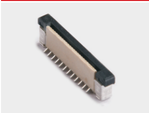
CONN FFC 0.50mm,SMD, Vertical,with ZIF
